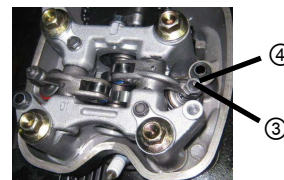
链条机气门间隙调整
